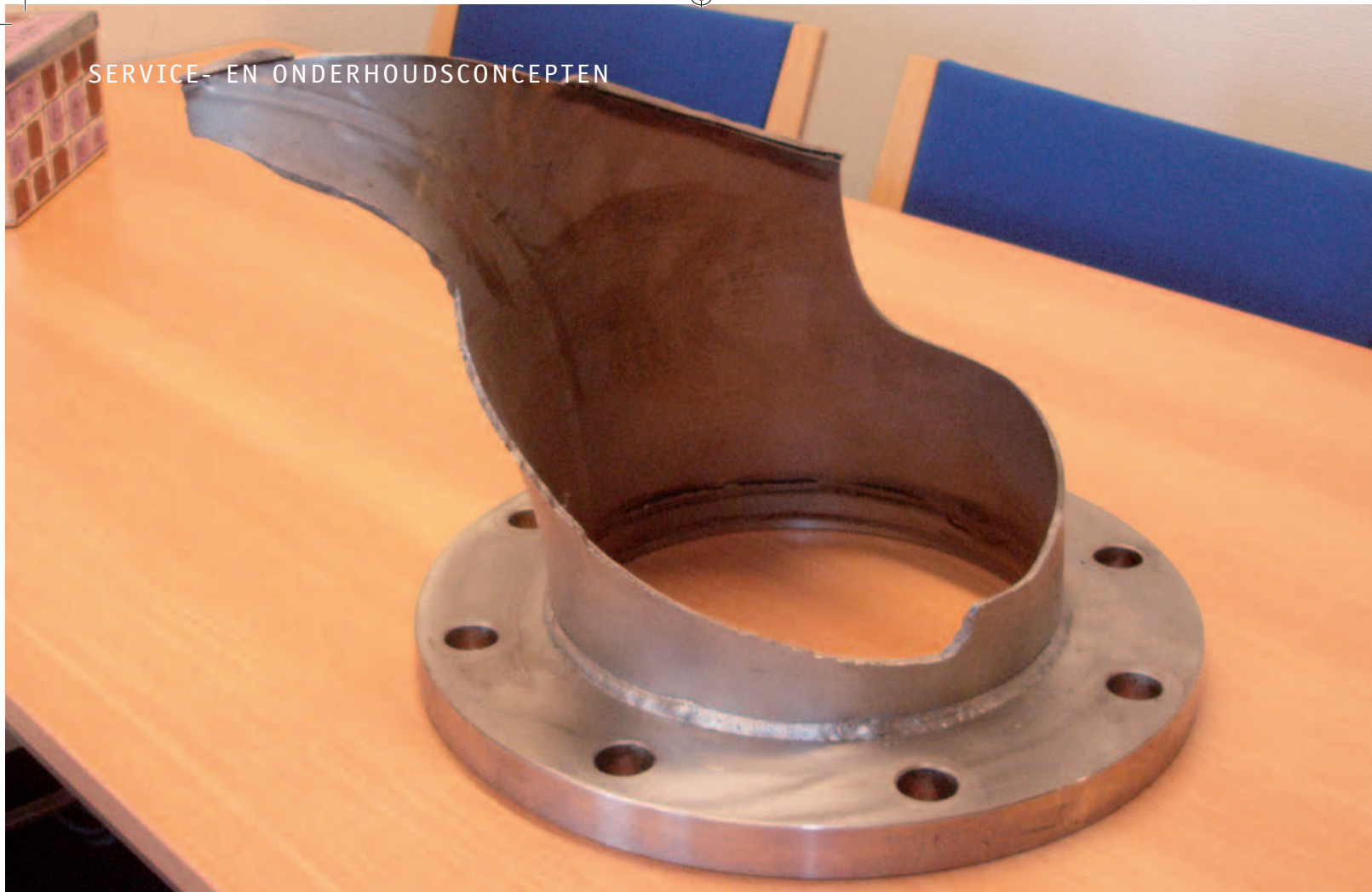
De moderne roestvast stalen leiding die tijdens de renovatie in het boostergemaal is aangebracht, blijkt de veroorzaker van de reuring
