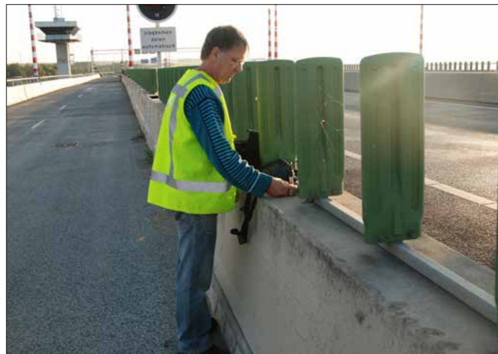
Bepaling eigen frequentie brug.
