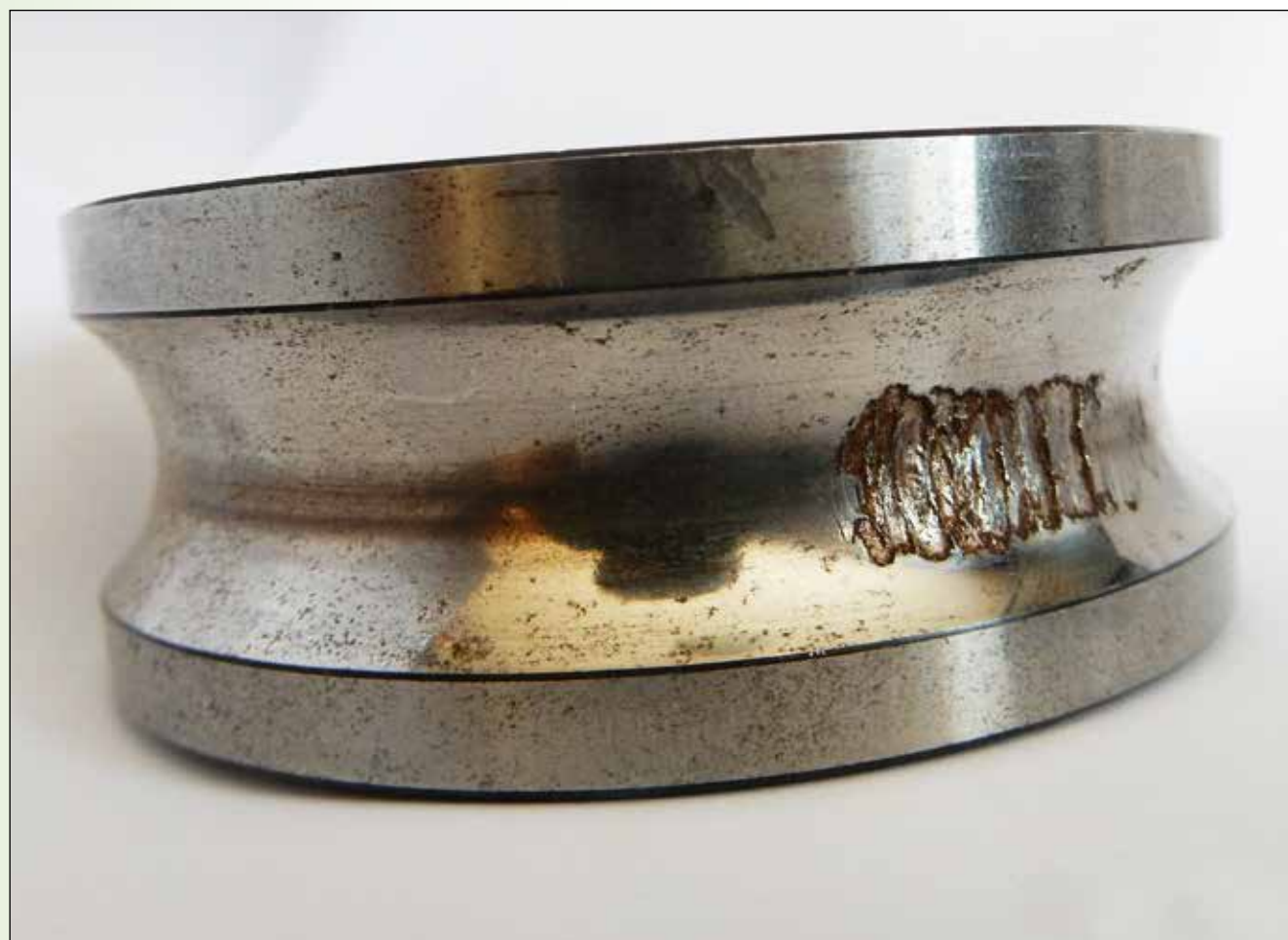
Beschadigt lager trilt 0,2 millimeter per seconde.
