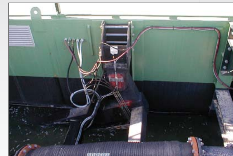
Een detailopname van het scharnierpunt van de ladder aan het schip.
