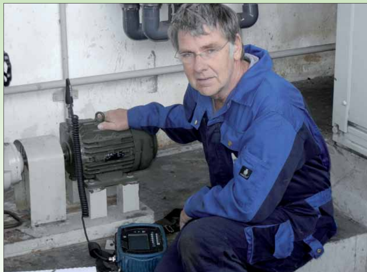
Van de horizontale en aiale richtingen wordt hier de verticale digitaal gemeten
